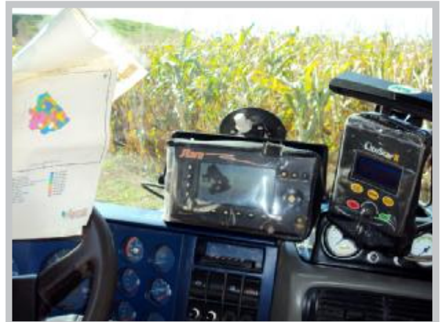
Caminhão com equipamentos para aplicação de corretivos nas lavouras utilizando GPS. Detalhe do painel com instrumentos de operação
